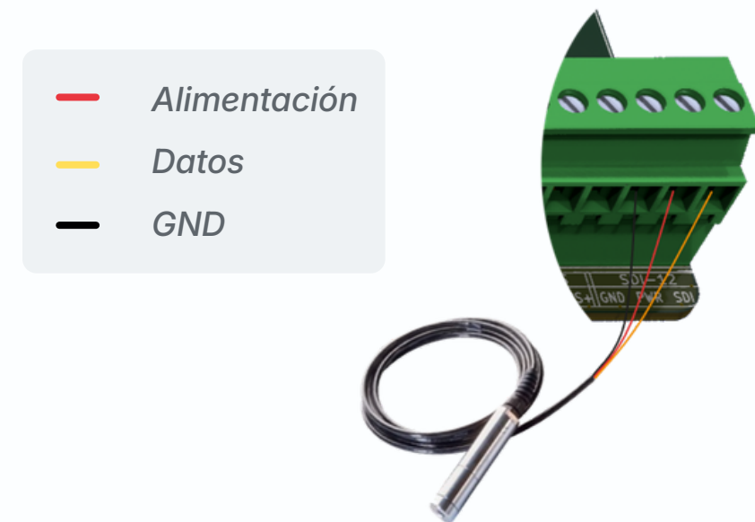
Figura 7. Conexión de una sonda SDI-12
