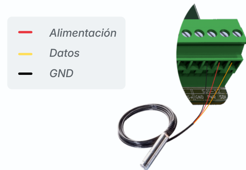
Figura 7. Conexión de una sonda SDI-12
