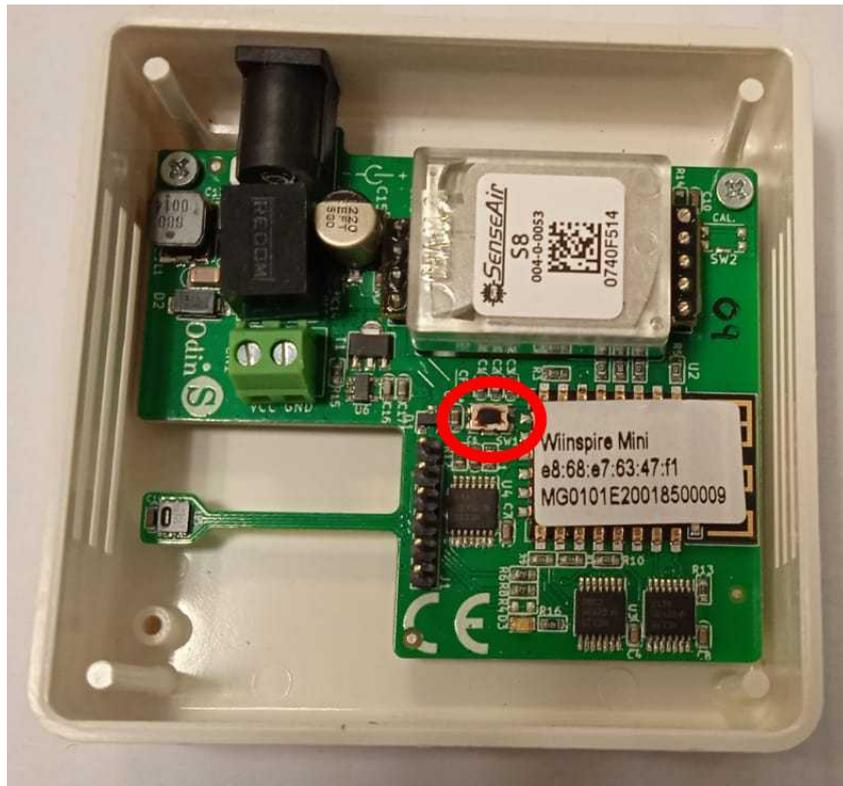
**Figura 1.** Pulsador para entrar al modo de configuración
