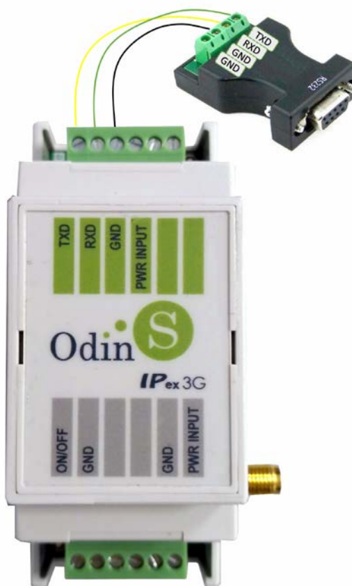
Figura 4. Conexionado de un dispositivo RS-232
