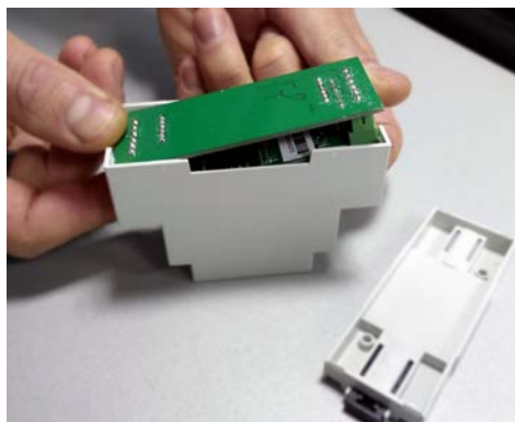
Figura 6. Extracción de la placa electrónica
