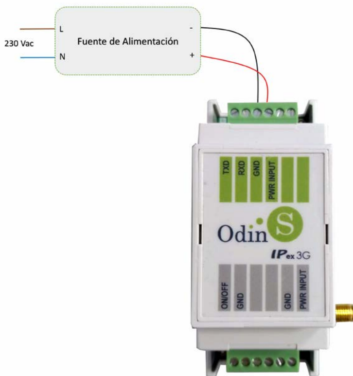
Figura 2. Disposición de los bornes de alimentación
