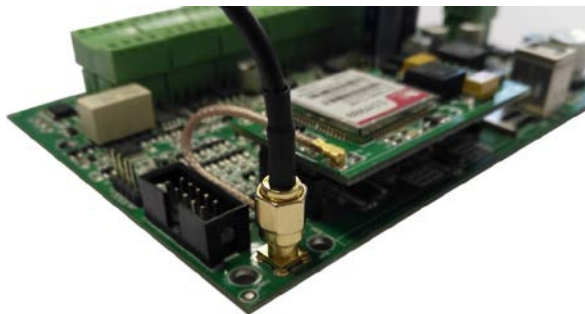
Figura 14. Conexionado de la antena GPRS
