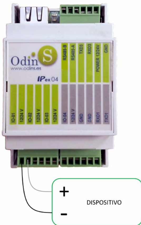
Figura 3. Conexionado de una salida digital
