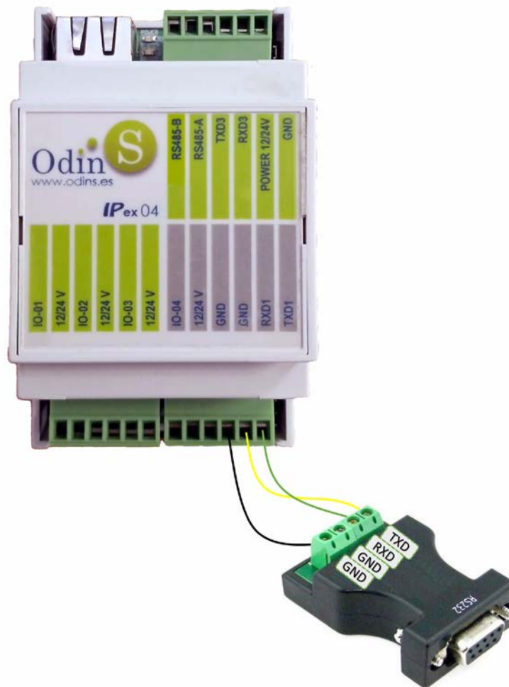
Figura 8. Conexionado de un dispositivo RS-232
