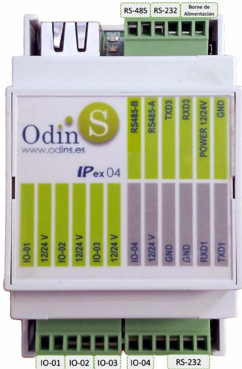
Figura 1. Disposición de las conexiones del IPex04
