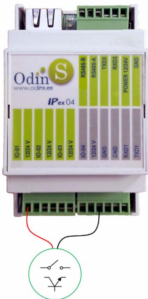
Figura 4. Conexionado de una entrada digital
