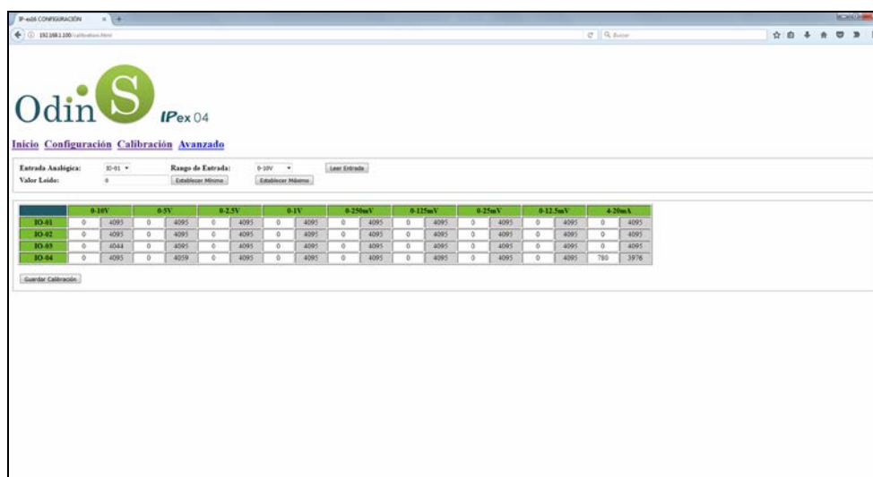
Figura 13. Calibración entradas analógicas
